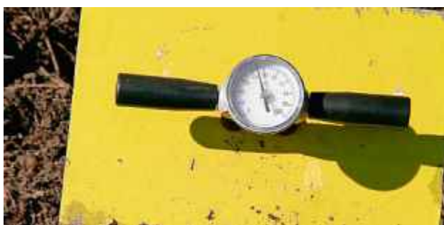
Steigt die Temperatur im Fermenter auf 42 bis 55 Grad Celsius an, sprechen Experten von thermophiler Vergärung. Foto: Cornelia Müller
